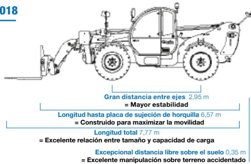
3 modos de dirección y excelente radio de giro interior/exterior 1,48 m/3,80 m
