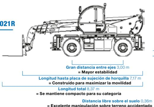
3 modos de dirección y excelente radio de giro interior/exterior 1,97 m/4,12 m
